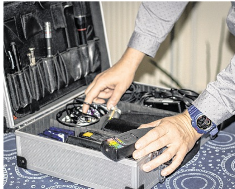
Der EMF-Messer misst elektromagnetische Felder.
